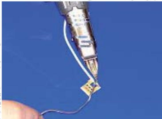
4) Pincez le contacteur sur la plaque sur l'une des surfaces situées à gauche ou à droite de la phase.
